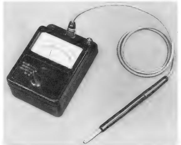
Bild 3. Das handliche Temperaturmeßgerät Thermizet von Siemens & Halske
