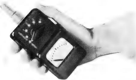
Bild 10. „Wechselspannungsdetektor“ der französischen Fa. Brion, Leroux & Cie., bestehend aus Suchspule, Transistorverstärker und Instrument
