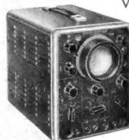
Vielseitig verwendbar in der HF-, NF- und Elektrotechnik. Vertikal-kaussteuerg.: 4 Hz - 4 MHz (Maximalverstärk. 1500fach) Breitbandverstärker: Frequenz-Bereich 2 Hz - 2 MHz. Mit Bildröhre B7 S1 und 5 x ECC 81, 1 x EZ 80, 2 x 6X4
